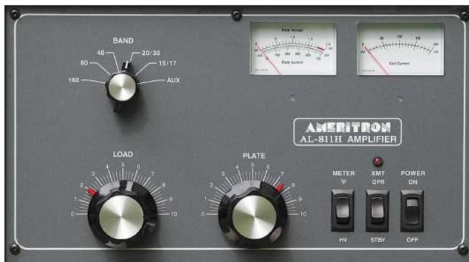
Bild 1: Frontansicht der AL-811HXCE – oben rechts das Instrument für Gitterstrom, links daneben jenes für Anodenstrom/-spannung; links oben der Bandschalter, darunter die Regler für den Anodenkreis
