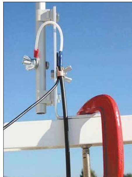
Bild 1: Montage und Einspeisung; das Radial geht schräg nach links unten weg. Mit der Schraubzwinde wird die Antenne befestigt.
