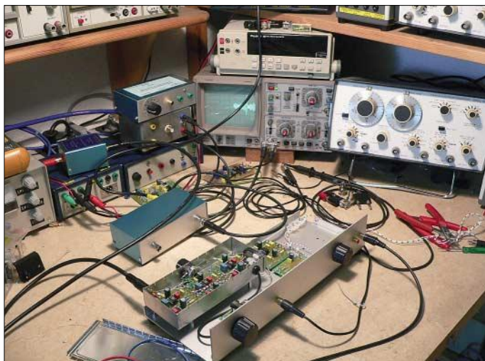
Der Versuchsaufbau der Schaltungsapplikation wurde auf einem Winkelblech realisiert. Die drei in Reihe geschalteten selektiven Filter finden dabei in einem aufmontierten abgeschirmten Weißblechgehäuse Platz (hier Deckel geöffnet). Vorn erkennt man die Einstellknöpfe für die Ausgänge „Träger“ und „NF“. Rückseitig befindet sich das Pegel-Potenzio-meter für die Filter. Fotos: DG9WF
