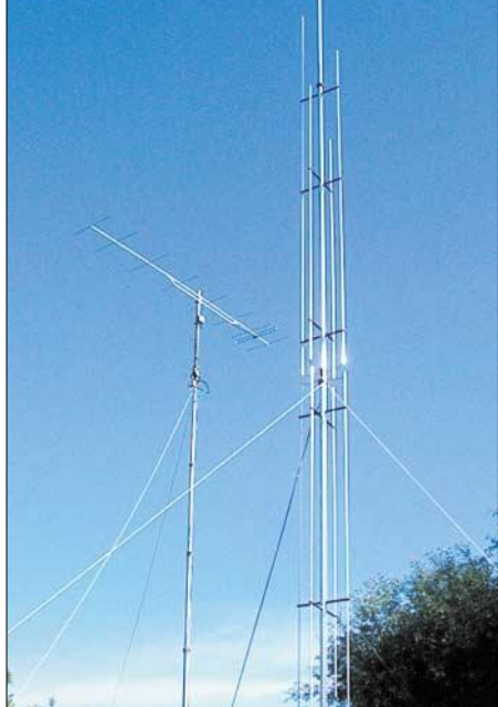
Bild 10: Fertig aufgebaute Antenne; ein Einfluss des 10 m entfernt stehenden UKW-Mastes konnte durch zeitweiliges Herunterkurbeln ausgeschlossen werden. Fotos: DL2RD
