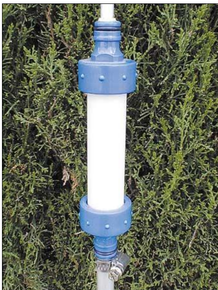
Bild 3: Das PVC-Rohr für die obere Verlängerungsspule wird von zwei Hahnstücken mit 3/4-Zoll-Innengewinde abgeschlossen.
