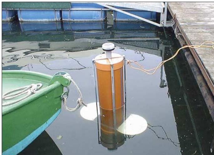
Die Treibboje bei Vorversuchen im Hafen des MCP (Motor-Boot-Club Pfalz e.V.) am Kiefweiher bei Ludwigshafen/Rhein. Deutlich erkennbar sind die seitlichen Flügel unter der Wasserlinie, welche die Schwingungen des Rohres dämpfen sollen.
