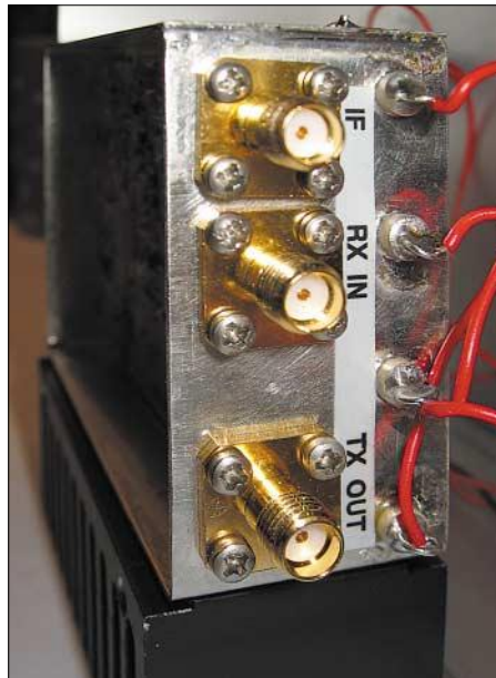
Bild 14: SMA-Buchsen und Durchführungskondensatoren an der Außenseite
