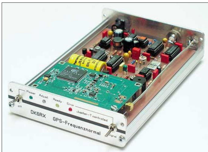
Bild 2: Das Herz des Frequenznormals besteht aus einem GPS-Empfänger.
