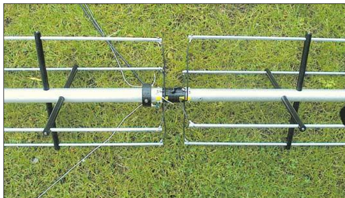
Bild 7: Bereit zum Aufstellen: Zwei der Abspannungen (Pfeile) sind bereits auf richtige Länge gebracht und mit den zugehörigen Heringen verbunden; in Richtung der dritten Abspannung erfolgt das Aufstellen.
