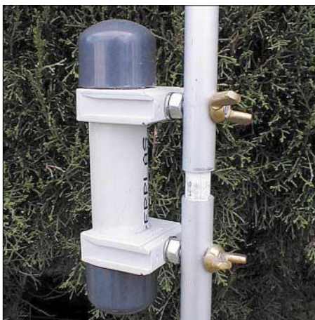
Bild 2: 20-m-Verlängerungsspule; die beiden Flügelmuttern dienen auch zum Festklemmen des Kurzschlussbügels für 17 und 15 m.
