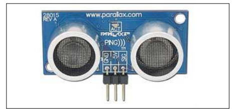
Bild 3: Die beiden Ultraschallsensoren sitzen auf der Vorderseite des Ping-Moduls – die Auswertelogik auf der Rückseite.
