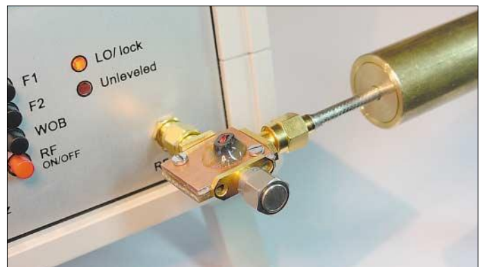
Bild 3: Messanordnung mit angeschlossenen Detektor (rechts) und einem SMA-Abschlusswiderstand (vorn) als Messobjekt (DUT). Fotos und Screenshots: DG4RBF
