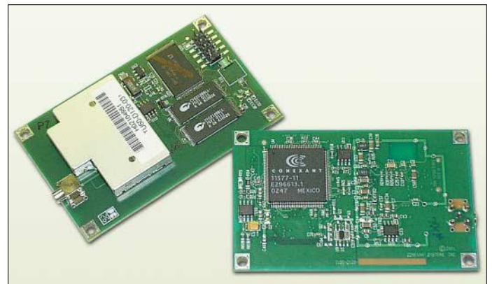
Bild 1: Die letzte Version einer der vielen Prototypen, die bei der Entwicklung für Tests und für die Optimierung des Frequenznormals aufgebaut wurde.
