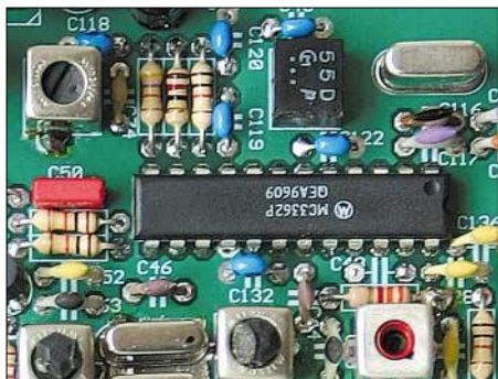
Bild 6: Ausschnitt aus der Hauptplatine. Der Bestückungsaufdruck und die ausführliche Baumappe erleichtern die schrittweise Bestückung.
