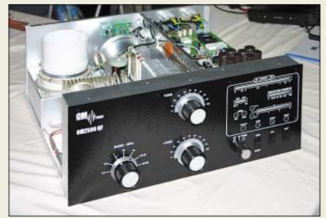
Power von OM-Power aus der Slowakei: Die KW-PA OM2500 HF wiegt komplett mit Netzteil 38 kg und leistet mit einer GU-84 2,5 kW – weit oberhalb des hierzulande Zulässigen.
