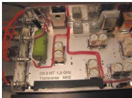
Bild 10: Transvertermodul mit eingelöteten Durchführungskondensatoren
