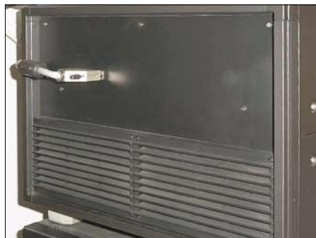
Bild 2: Ein lackiertes Blech mit Sub-D25-Buchse deckt die Frontseite nach dem Umbau ab.
