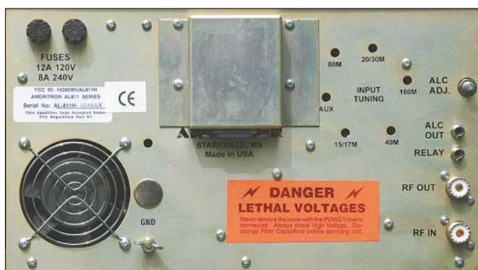
Bild 2: Rückansicht der Endstufe mit selbsterklärender Beschriftung; rechts oben die Löcher zur Justierung des Eingangskreises, rechts daneben der Regler für die ALC
