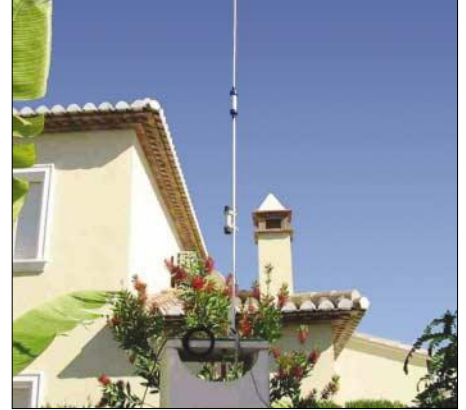
Bild 4: Montage der Antenne bei EA5AEF/DJ3VQ; die beiden Verlängerungsspulen und die Mantelwellendrossel am Fußpunkt sind gut zu erkennen. Fotos: DJ7BU
