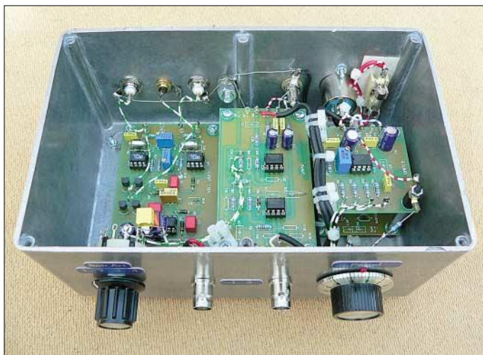
Bild 1: Selbst mit einfachen Mitteln lassen sich Messverstärker, wie dieser für den ELF-Bereich, mit sehr hohen Eingangswiderständen und einer großen Gleichtaktunterdrückung aufbauen. Alle Platinen wurden dem UAP-System entnommen.
