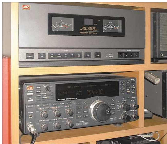
Bild 4: Nach dem Umbau befindet sich die Bedienungseinheit direkt über dem Transceiver, während der Rest der Endstufe im Nachbarraum lautstark lüftet.
